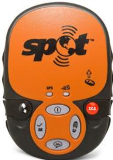
GPS Spot generador de señales SOS, mensajes de texto a celulares configurados en el spot., esta señal llega a una central en EEUU y reenvían el mensaje al número de emergencia.
